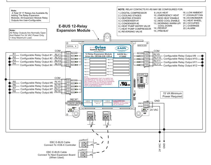
Figure 36: OE358-23E-12R-A – E-BUS 12-Relay Expansion Module Wiring
